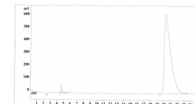
Abb. 8: [EMIM] N(CN) 2 . Eluent: 2,00 mM NaHCO 3 , 2,40 mM Na 2 CO 3 in 950 ml Wasser u. 50 ml Aceton. Skala: Metrohm Metrosep A, Supp. 4, gemessen mit chem. Suppression.
